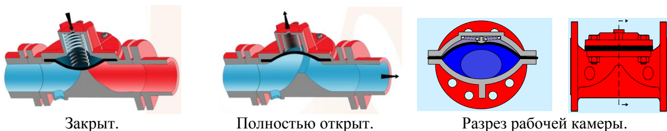
Рис. 5. Конечные положения регулирующей мембраны.
